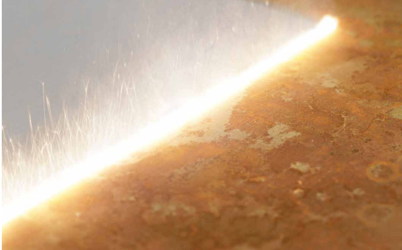
Entrosten mit Scangeschwindigkeit von bis zu 140 m/sec.
