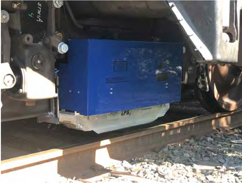
Das Schienenreinigungsmodul – kompakt, robust und einfach integrierbar
