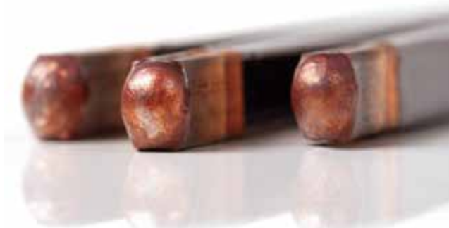
图2：IPG可靠的激光技术和短的焊接时间：在电机定子制造中的铜端子焊接。
