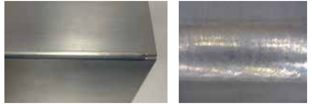
6061-T6 铝合金上角焊缝（厚度1.5 毫米）。左图显示了整体质量，而右侧的显微图像显示了接缝情况。
